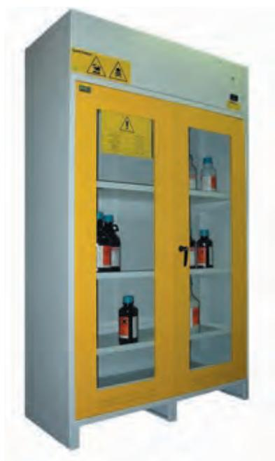
Шкафы для хранения кислот и щелочей могут поставляться с дополнительным вытяжным блоком, который устанавливается сверху на шкаф. Блок состоит из установки аспирации IMQ IPX4 CE, угольного фильтра CARBOX со сменными картриджами и электронного устройства CUNCLATOR (контроль насыщения фильтра и необходимость его замены).
