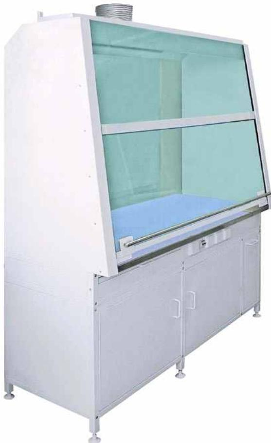
Предназначены для проведения работ по органическому синтезу и с вредными химическими веществами, нефтепродуктами, растворителями, легковоспламеняющимися жидкостями, тяжелыми газами, кислотами и щелочами. Могут комплектоваться электрикой во взрывозащищенном исполнении (ВЗБ), а также газовым краном. Шкафы оборудованы ударостойкими подъемными экранами из стекла "триплекс" с максимальной высотой подъема 600 мм, вытяжкой из нижних тумб. Устанавливаются на регулируемые опоры.
