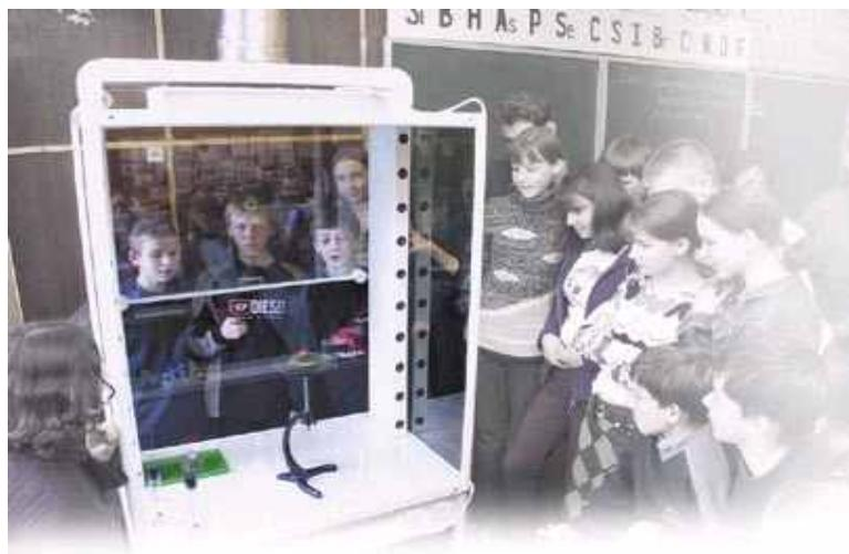
Предназначены для проведения работ по органическому синтезу и с вредными химическими веществами, нефтепродуктами, растворителями, легковоспламеняющимися жидкостями, тяжелыми газами, кислотами и щелочами. Боковые и задние стенки, подъемный экран выполнены из нетонированного стекла, что дает возможность контролировать процесс со всех четырех сторон.
