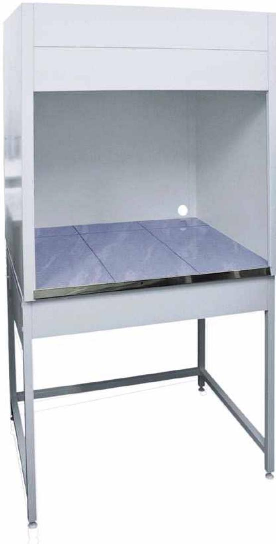
Предназначены для установки муфельных печей и сушильных шкафов. Устанавливаются на регулируемые опоры. Столешница выполнена из керамики. Внутренний габарит шкафа: 976x796x1050
